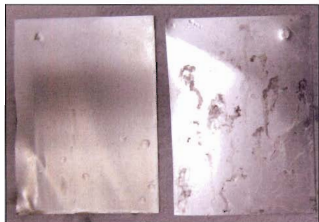
Fig.7 – camp.2 e 3 Alluminio dopo 24 h di esposizione
