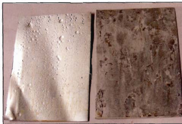
Fig.9 – camp.2 e 3 Alluminio dopo 192 h di esposizione
