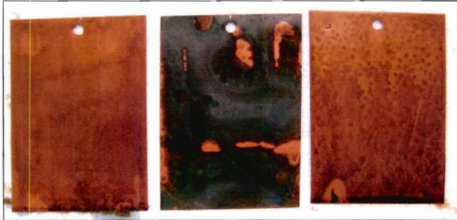
Fig.20 – campioni 4 (corrosion a sx) e 5 (electric a dx) a confronto con un campione di riferimento non protetto (al centro) dopo 120 ore di esposizione ai vapori ammoniacali
