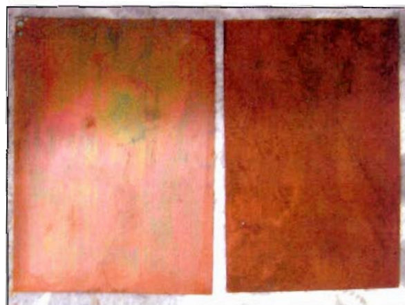
Fig.14 – camp.2 e 3 Rame dopo 24 h di esposizione
